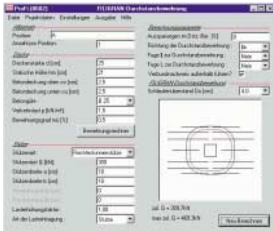
Bild 6. Eingabe der Systemdaten für den Durchstanznachweis [8]
